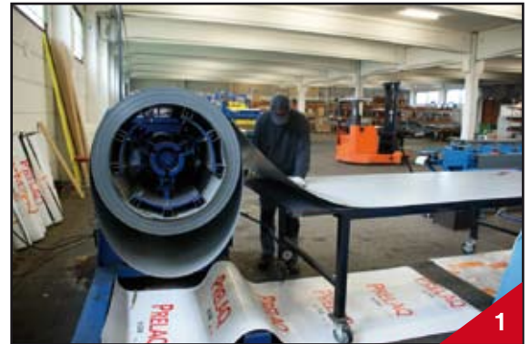
Aamupäivällä Selmok Oy:n tuotantotiloissa on kiirettä, sillä illalla ovat tulleet pellitettävien kattojen mitat ja nyt leikataan niitä sopiviin muotoihin. Erikoismuodot mitataan ja leikataan
